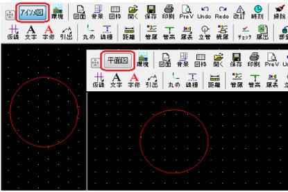
同一図面内に平面図とアイソメ図を同時に描く事ができます。平面図とアイソメ図の切り替えはモード替え釦や TAB キーで行います。グリッドの形が替わり、枠選択の形状もモードに合ったものになり操作性を向上させています。
